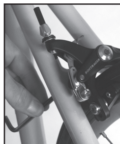
Figura 5: apriete la tuerca de ajuste
